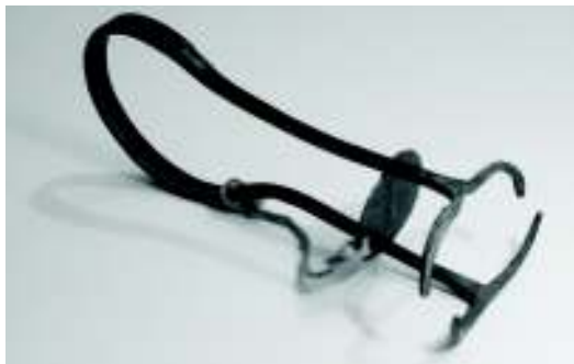
PAST ZA VOLUHARJE, ISKANI IZDELEK ŽIROVSKIH KOVAČEV PRED 2. SVETOVNO VOJNO FOTO: BORUT SLABE
